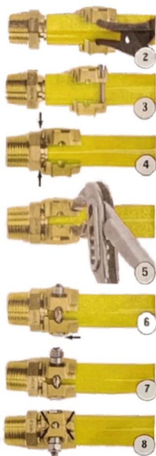
Figure 9 – Réalisation des assemblages avec les raccords à compression JENTRO
